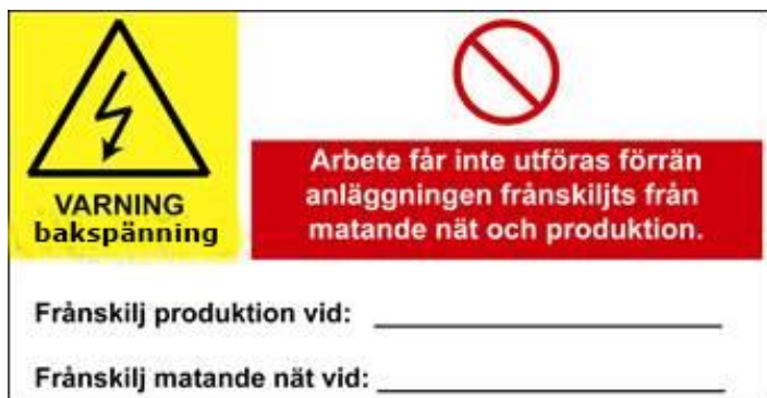
Figur 5 Exempel på skylt som varnar för bakspänning.
