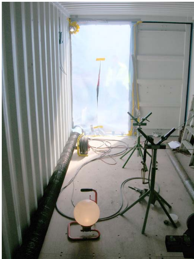
Bild 12, till vänster. Till och frånluftsdonens placering i plasten ses det hål som användes mellan försöken för passage in och ut samt för utvädring av koloxid efter avslutad mätning. Under mätningar var hålet i plasten igentejpad.
