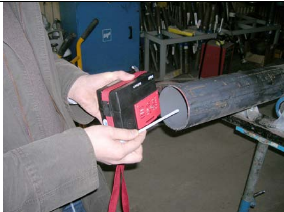
Bild 22. Parallellmätningen i den övre rörändan under svetsning. På bilden ses MultiwarnII och en slangända som är kopplad till IR-instrumentet.
