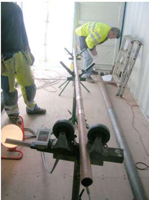
Bild 21, ovan. Försöksuppställningen före lödningen vid skarvning av kopparrör.
