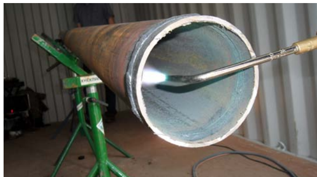
Bild 20, Nedan. Svetsläga hållen riktad in i röret. Mätning av koloxid utfördes i andra högre belägna rörändan (syns ej på bilden).
