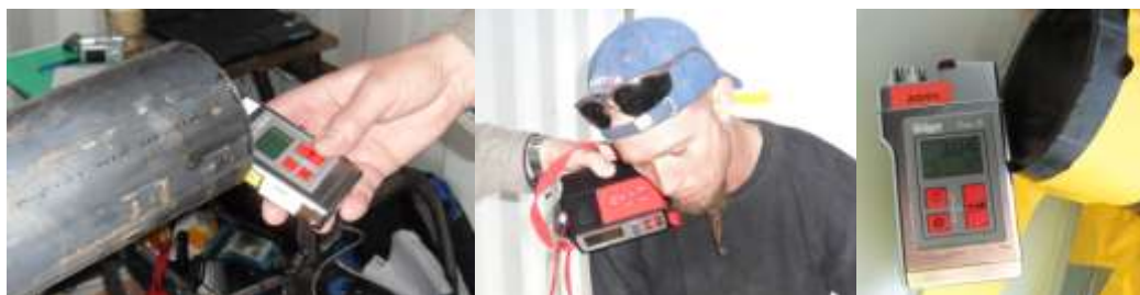
Bild 2. Mätning i andningszon, i rörände och i frånluft.
