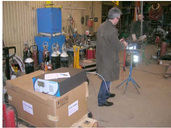
Bild 23. I förgrunden FTIR-instrumentet från Ecotech, modell Serenius 30 CO. Bakom personen som håller i mätinstrumenten ses röret och därbakom svetsaren som på bilden ännu inte påbörjat svetsfogen.
