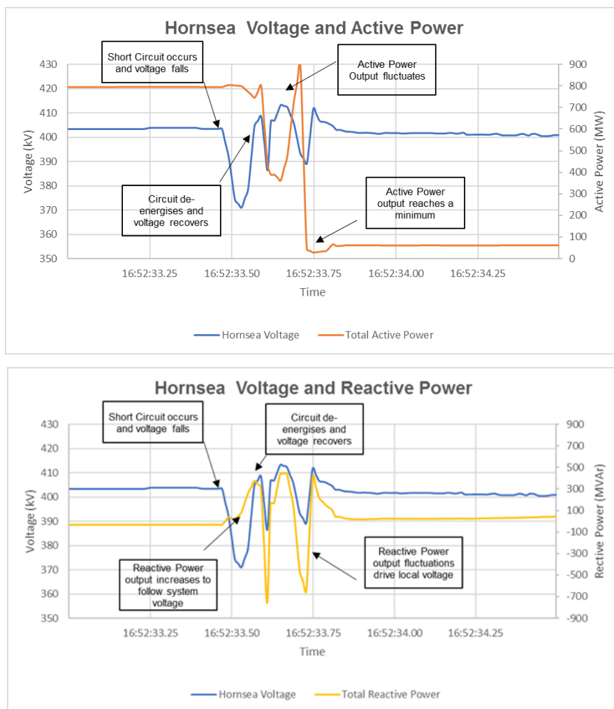
Figur 11 Spänning och aktiv effekt (överst), samt spänning och reaktiv effekt (underst) vid Hornsea i samband med störningen den 9 augusti 2019 [13].
