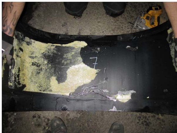
Bild 2. Vidhäftningen mellan muff och skum var ofta bra på en del och dålig på resten.
