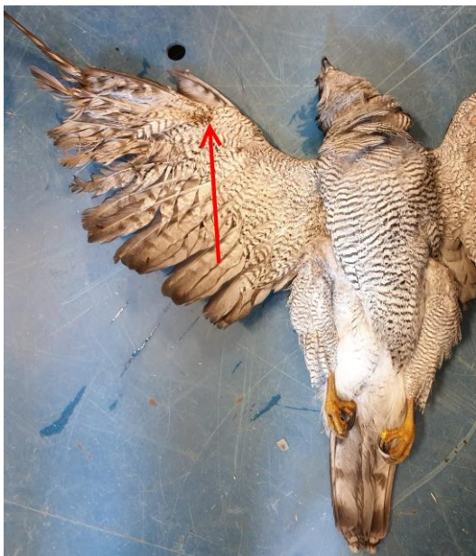
Figur 17. Den röda pilen visar brännmärke där strömgenomföring uppkom vid försök med död duvhök på KTH:s Högspänningslaboratorium.
