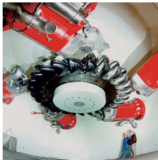
Figur 8: 7, Peltonturbinens arbetsprincip samt foto av ett modernt löphjul.
